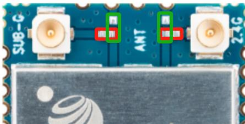
图 5. 天线输出方式更改
