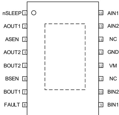
注: eTSSOP16 封装的外露焊盘需要连接到 GND。
