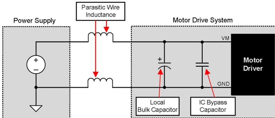
图 6 带有外部电源的电机驱动系统设置示例
